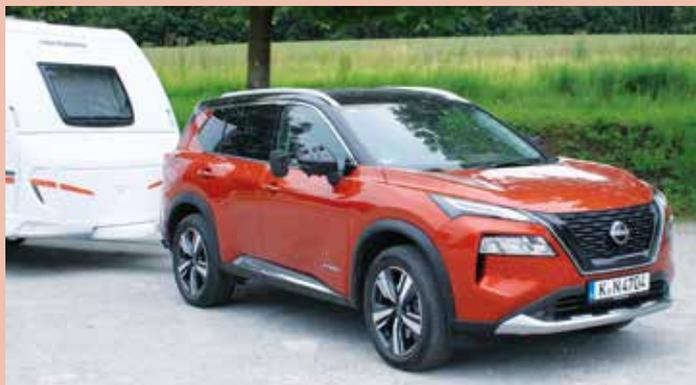
Im X-Trail kommt auch das speziell auf elektrifizierte Antriebe abgestimmte e-4ORCE Allradsystem zum Einsatz. Das leistungsstarke System entwickelt dank eines zusätzlichen 100-kW-Elektromotors an der Hinterachse eine Gesamtleistung von 214 PS und beschleunigt damit in sieben Sekunden von null auf 100 km/h. Darüber hinaus tragen die konstante Drehmomentverteilung und die nahezu perfekte Gewichtsverteilung zu einem kontrollierten Handling und hohem Fahrkomfort bei.
