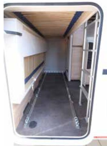
**Durch das Hochklappen der unteren Liegefläche entsteht ein geräumiger Stauraum, der auch durch die Außentür gut zugänglich ist**
