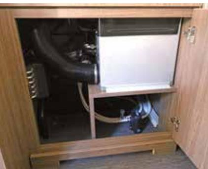
Die leistungsstarke Alde-Heizung und das Frostwächterventil befinden sich gut erreichbar unter dem Kleiderschrank
