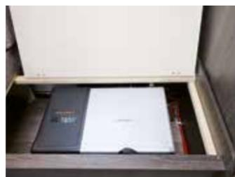
Die Alde Heizung befindet sich gut zugänglich im linken Sitzkasten, allerdings sind die Ablassventile versteckt eingebaut
