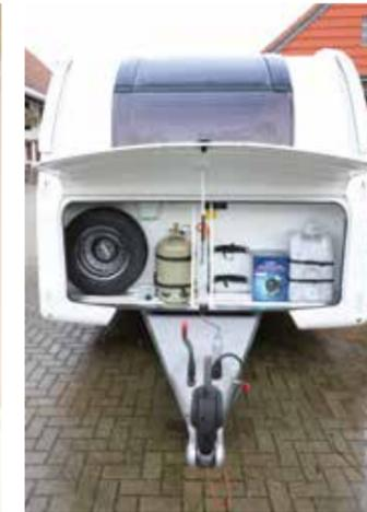
Geräumiger Deichselkasten mit leicht zu öffnender Kunststoffklappe
