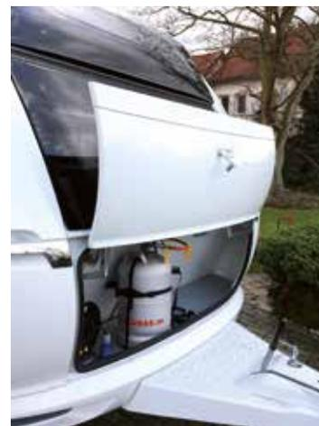
**Geräumiger Deichselkasten mit leicht zu öffnender Kunststoffklappe**
