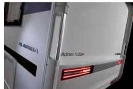
Automotiver Heckabschluss mit modernen LED-Rückleuchten
